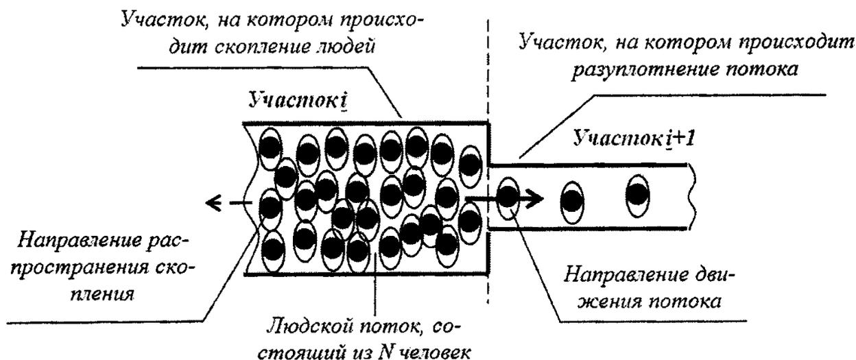
Рисунок Пб.1. Пояснения к расчету параметров людского потока
